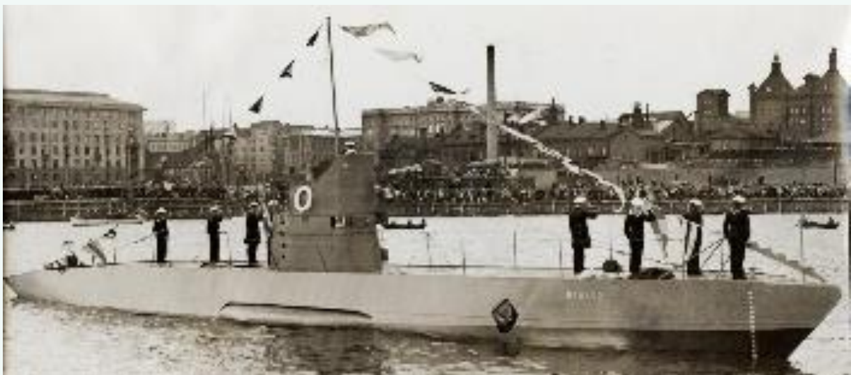
El sumergible fines Saukko , durante su botadura en las aguas de Helsinki en 1930. Siguiendo un Tratado de 1920 entre Rusia y Finlandia, los nuevos buques de la zona no podían tener más de 100 Tm. Este pesaba 99 y llevaba minas y torpedos. Foto de la Wikipedia.
