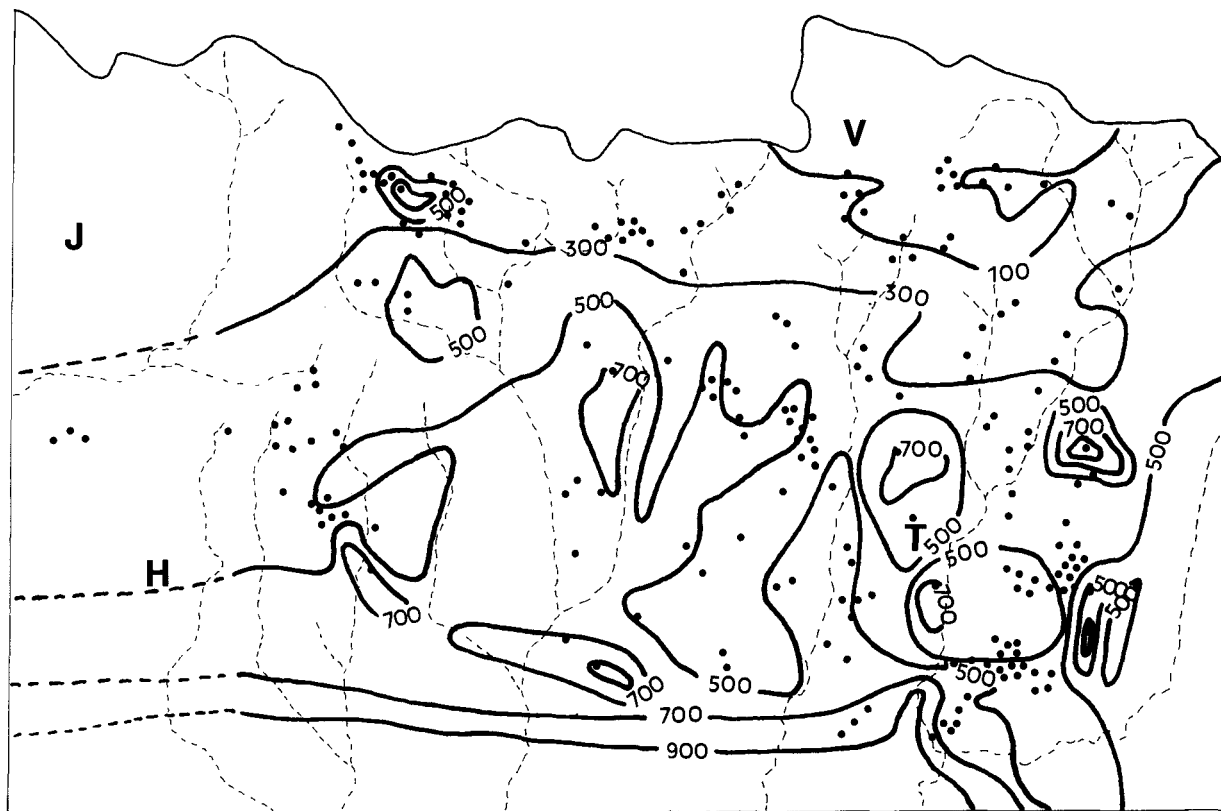
Figura 5.- Mapa de isoclasas a partir de las conductividades eléctricas de las fuentes muestreadas. Electrical conductivity map obtained from the sampled springs.
